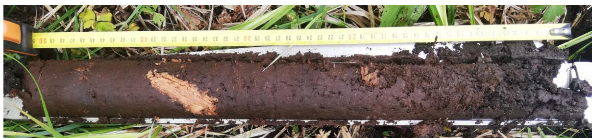
Fot. 1. Pobór osadów torfowych próbnikiem Instorf.
